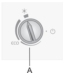
**Включване на функцията freezer boost (силно замразяване):** Завъртете диск **A** в позиция **\***.
